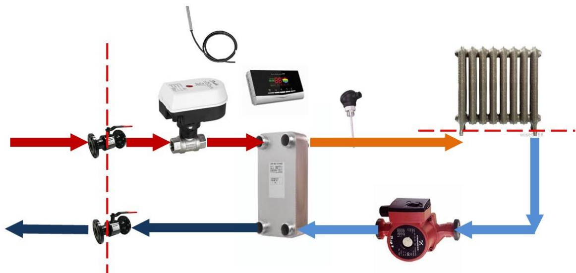
5.24. pav. Nepriklausomo šildymo pajungimo (automatizuotas) šilumos punktas: be karšto vandens ruošimo šilumokaičio. Pagrindinių įrenginių vizualizacija.
